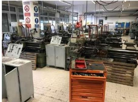
E' correttamente arredato. Gli impianti elettrici sono conformi e i cavi elettrici scendono dall'alto e non costituiscono un pericolo di inciampo o di incendio. L'impianto elettrico è alimentato da proprio quadro elettrico conforme, chiuso con sportello e con utenze chiaramente etichettate e identificate.
