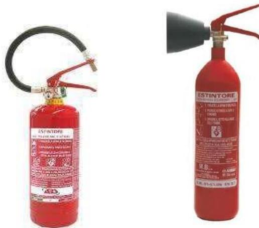
Essi sono stati correttamente installati, segnalati ed adeguatamente disposti ad una distanza tra loro non superiore a 30 mt ed inoltre hanno una copertura di almeno mq/cad 100 relativo ad attività con livello di rischio incendio medio. Il numero e la capacità estinguente degli estintori portatili presenti nell'e sedi scolastiche sono stati valutati tenendo conto dei valori di classe A e B, e dei criteri di seguito indicati:
